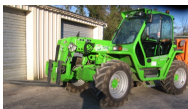
Fourches pour le transport et la manipulation de palettes
