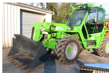
Godet à terre pour le terrassement, le transport et le chargement
