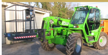
Nacelle 2 personnes couvrant l'ensemble des besoins d'entretien en hauteur.
